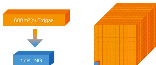
**↘ Aus einer Volumeneinheit LNG werden etwa 600 Volumeneinheiten Erdgas.**
